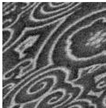
Abbildung 25. PEEM-Aufnahme einer Pt(110)-Oberfläche im Zustand chemischer Turbulenz. T = 548 \text{ K} , p_{\text{O}_2} = 4 \times 10^{-4} \text{ mbar} , p_{\text{CO}} = 1.2 \times 10^{-4} \text{ mbar} . Der Bildausschnitt entspricht 360 \times 360 \mu\text{m} . In den Hintergrundinformationen ist eine Echtzeit-Filmaufnahme der Musteränderungen zu sehen.
